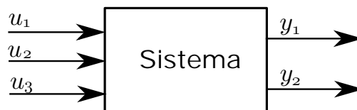
Figura 1.3: Diagrama de bloques de un sistema dinámico de 3 entradas y 2 salidas
